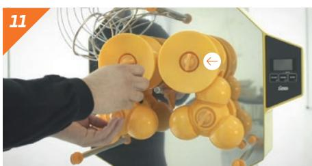
Allentare le manopole di fissaggio delle unità di spremitura.
