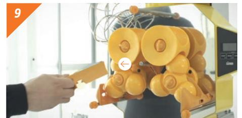
9 Desmontamos la cuchilla tirando del asa hacia nosotros. **¡Atención!** Esta pieza puede cortar.
