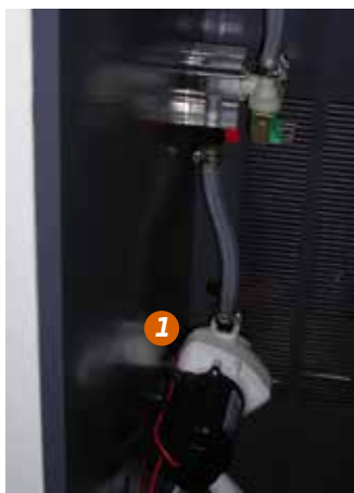
1- Pompa; 2-Valvola di ritegno; 3- Deposito di 10 L
