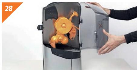
Colocamos la cubierta, insertando los pivotes en las bisagras.
