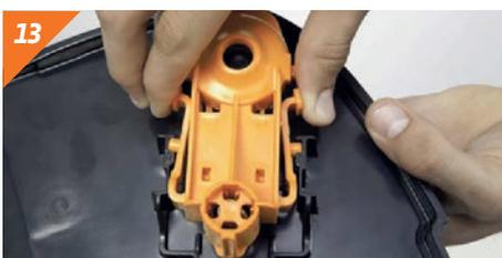
13 Para desmontarlo, presionamos los laterales del grifo con el fin de soltar los pivotes.
