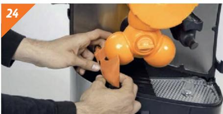
Colocamos la cuña extractora, insertándola lateralmente en los pivotes.
