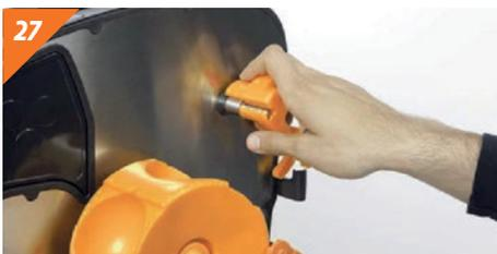
Colocamos el retenedor en el eje y nos aseguramos de que queda clipado y el movimiento es suave.
