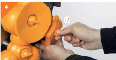
4 Soltamos el conjunto cuchilla girando 180° el bloqueo de seguridad.
