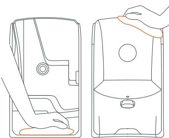
È possibile pulire l'interno e esterno della macchina con un panno umido e sapone neutro.
