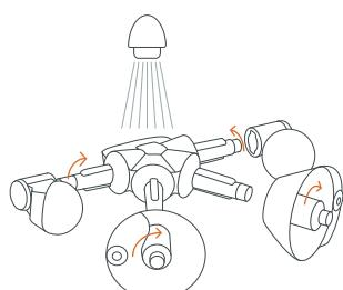
Per un lavaggio accurato dei pezzi che lo compongono, ruotare di un quarto di giro le **Chiusure dei tamburi**.
